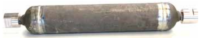
Für Berstversuch vorbereiteter Behälter
