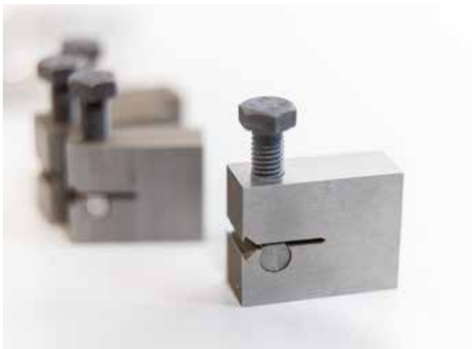
Bruchmechanik-Proben mit Schraube zum Aufbringen der konstanten Verformung
