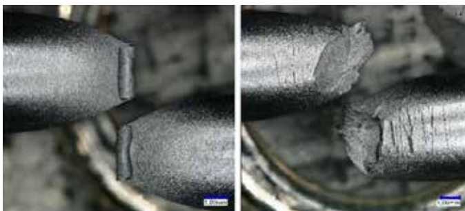
SSRT-Proben nach dem Versuch - in N2 (links), in H2 (rechts)
