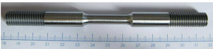
Abbildung 3: Rundzugprobe für Slow Strain Rate Tests
